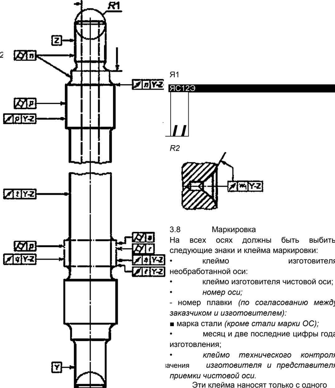
торца шейки оси на одной его половине, другая половина предназначена для маркировок изготовителя колесной пары.
